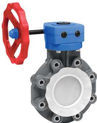
Esta válvula con forro de TFM de tecnología avanzada está diseñada y producida especialmente para aplicaciones que requieren alta pureza y máxima resistencia química. El sello de superficie de contacto del componente exclusivo de Spears®, aísla completamente el fluido de proceso para contacto solo en el disco y el forro. Están disponible en tamaños desde 2" hasta 6".
